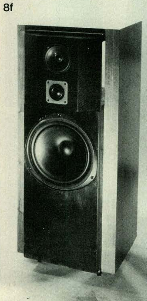
Figuur 8 (vervolg). In 8e zien we een zo goed als complete kast; alleen is het frontpaneel even verwijderd, om u een inkijkje te gunnen in het baskompartiment. Op de foto van 8f is de kast al helemaal gefineerd en zijn de luidsprekers op hun plaats gemonteerd — de zwenkwieltjes zitten er ook al onder, al is dat wat moeilijk te zien. Foto 11g toont hoe de grille eruit ziet, terwijl in 8h de kast echt helemaal klaar is.
